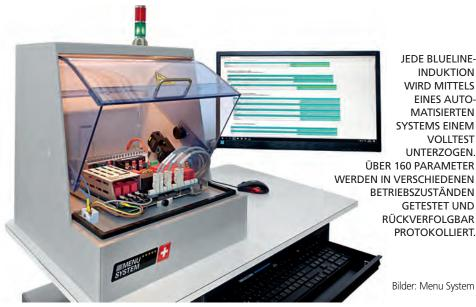
JEDE BLUELINE-INDUKTION WIRD MITTELS **EINES AUTO-MATISIERTEN** SYSTEMS EINEM VOLITEST UNTERZOGEN. ÜBER 160 PARAMETER WERDEN IN VERSCHIEDENEN BETRIEBSZUSTÄNDEN **GETESTET UND**
